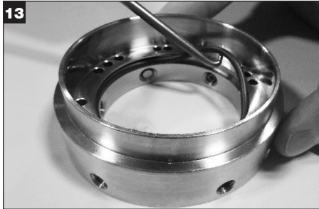
13 Odstráňte a zlikvidujte zamykací krúžok O-krúžku (Y).
