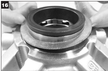
16 Tesnenie vyberte z adaptéra a zlikvidujte.
