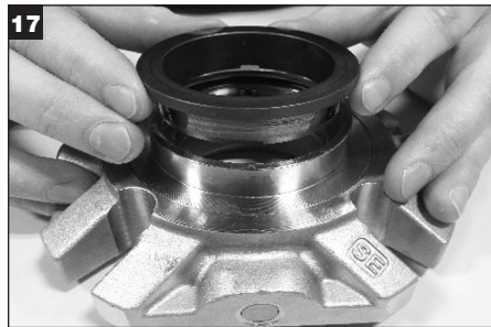
17 Stacionárny tesniaci krúžok prevodovky vyberte z príruby a zlikvidujte.
